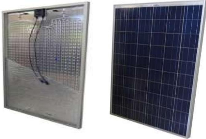
Grazie alla tecnologia Roll Bond è realizzato un modulo solare ibrido composto da un pannello fotovoltaico 60 celle , dove avviene la conversione dei raggi solari in energia elettrica, e da un collettore in alluminio detto roll bond posto in aderenza alla parte posteriore del pannello dove si ha generazione di energia termica che viene trasferita al fluido termovettore che scorre nel collettore.
